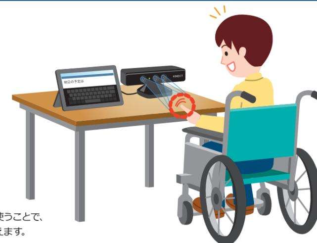
※ Windows と Kinect センサー、ソフトウェア「OAK」を使うことで、手などのわずかな動きを認識し、パソコンの操作などを行えます。
